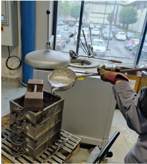
Figure 9 : Le métal est versé dans le moule à l'aide du creuset
