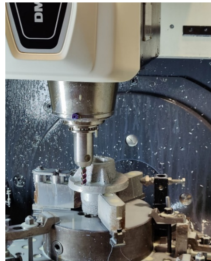
Figure 21 : Perçage de la surface H.
