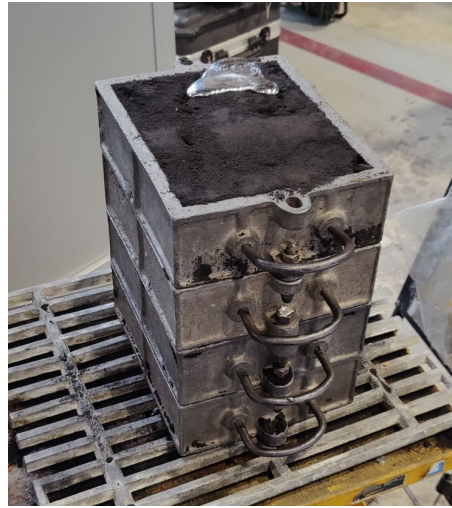
Figure 11 : l'alliage durci au sein du moule (refroidissement)
