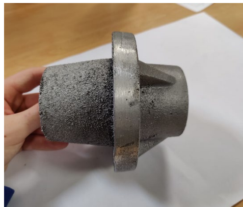
Figure 103 : Après refroidissement et nettoyage de la pièce
