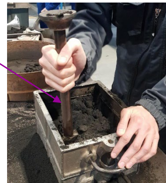
Figure 7 : Tassage de la silice autour du modèle (figure 7)
